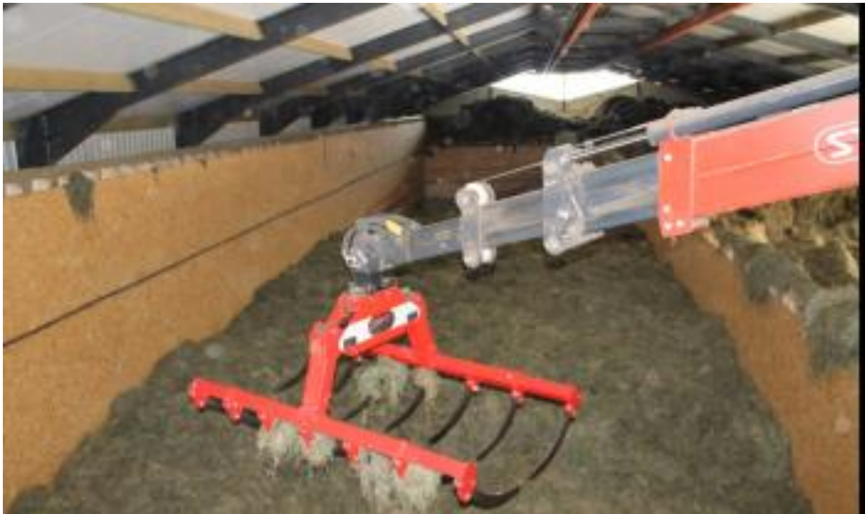
Figuur 2: De grijparm wordt gebruikt om de droogboxen in en uit te laden en het materiaal te herverdelen.
