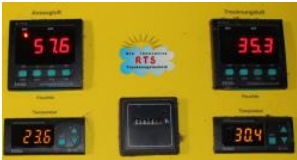
Figuur 5: Het bedieningspaneel geeft een de relatieve luchtvochtigheid en temperatuur weer van de aangezogen (L) en de uitgeblazen (R) lucht.
